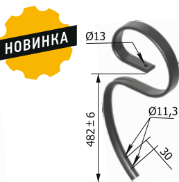
S-образная стойка 45x12 47.1202.02.02.002-01 М = 5,2 кг
