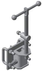
Механизм подъема в сборе РЗЗ.06.300-02 М = 13,41 кг
