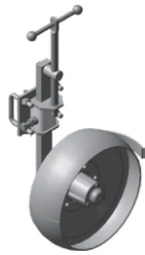
Механизм колеса РЗЗ.06.000 М = 61,2 кг
