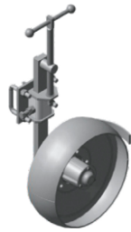
Механизм колеса РЗЗ.06.000-02 М = 61,16 кг
