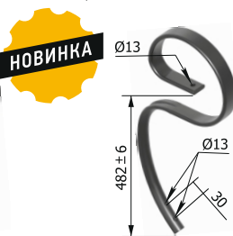
S-образная стойка 45x12 47.1202.02.02.002-03 М = 5,2 кг
